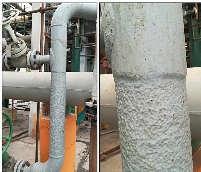
خوردگی شدید در زیر عایق لاین ۶ اینچ گاز طبیعی ورودی به مبدل 165-C آمونیاک ۲ و تفاوت محسوس آن با قسمت عایق نشده
